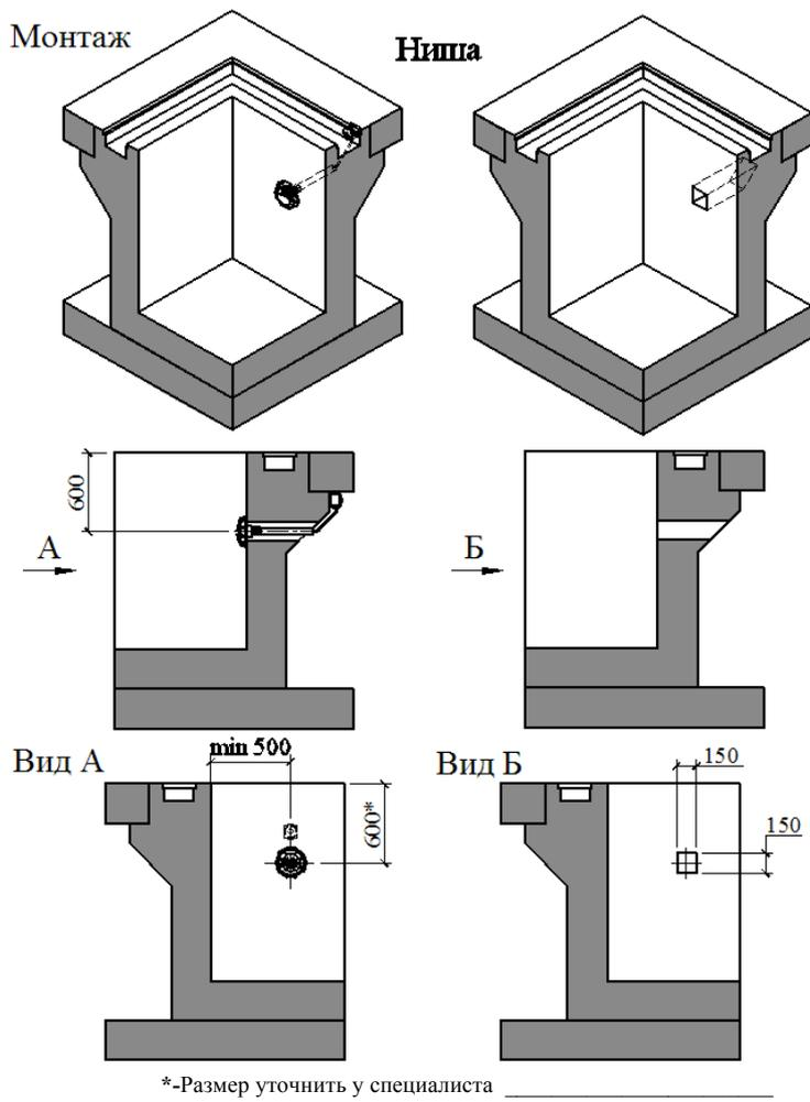
Рисунок 4 (Установка в скиммерный бассейн)
